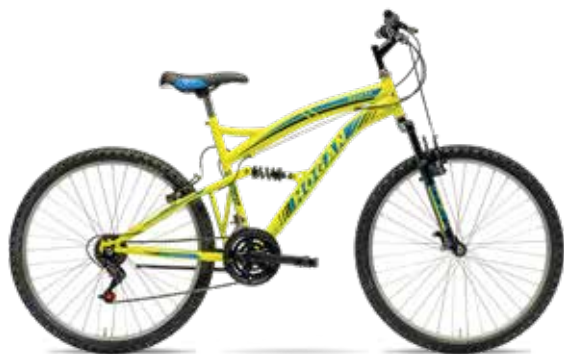
MOUNTAIN BIKE 26" 18V telaio in acciaio full suspension, forcella ammortizzata, cambio Saiguan 18 velocità, comandi Saiguan grip, freni V-brake in acciaio
