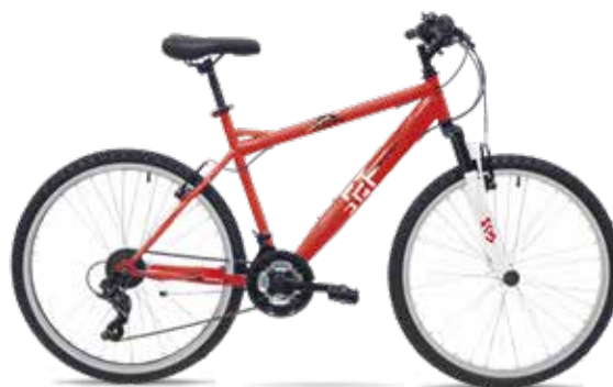
MOUNTAIN BIKE 26" 18V DENVER telaio in acciaio, forcella ammortizzata, cambio Shimano TY21 21 velocità, comandi Saiguan friction, freni V-brake in acciaio
